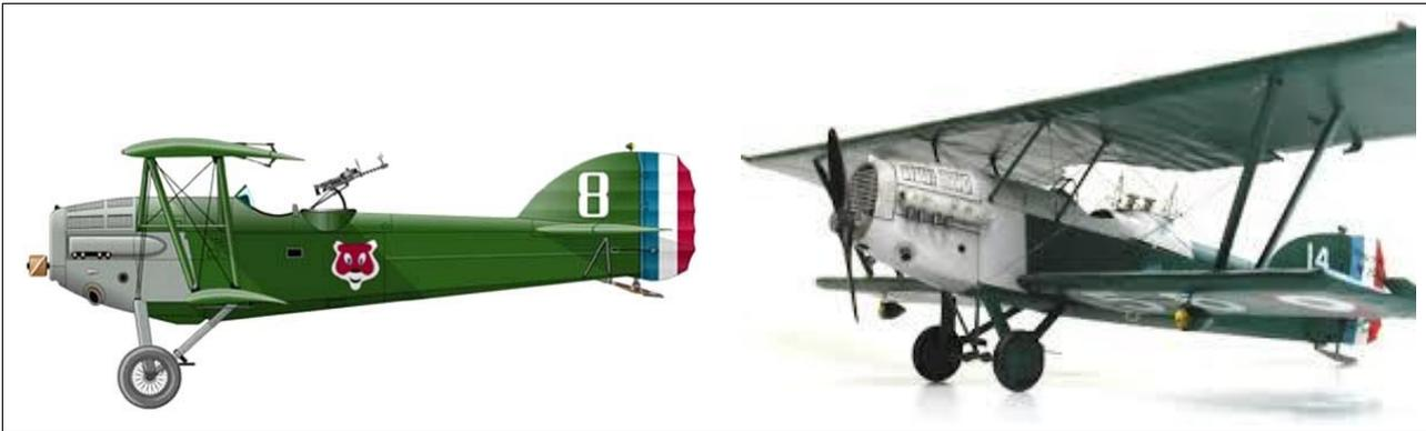
Le Potez 25 TOE (Theatre Opération Extérieure) est un biplan monomoteur d'observation et de bombardement français C'est une version tropicalisée du Potez 25 équipée de réservoirs supplémentaires, et d'un équipement spécifique.
