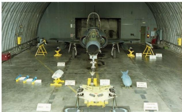
Chasseur-bombardier polyvalent, le Mirage III E peut emporter une vaste panoplie d'armements air-air et air-sol. Notez le châssis soutenant les deux canons DEFA 553 de 30 mm et les deux missiles à guidage infra-rouge de type AIM-9 B Sidewinder. L'emploi de la version « Bravo » de ce missile reste limité au tir en secteur arrière et à courte distance sous faible facteur de charge (Collection BA 116).
