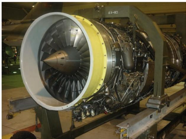
D'une masse de 1 500 kg le M 53 P2 développe 9.7 tonnes de poussée à pleine charge (DR).
