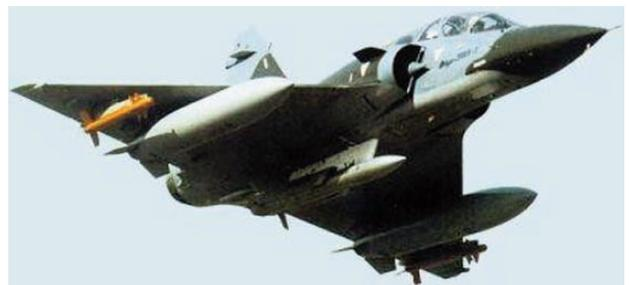
*Mirage 2000 N 01 en configuration de pénétration nucléaire. Pour cette mission l'avion est équipé de deux réservoirs pendulaires accompagnés de deux missiles à guidage infra rouge Magic II et d'un missile à charge thermonucléaire ASMP (DR).*
