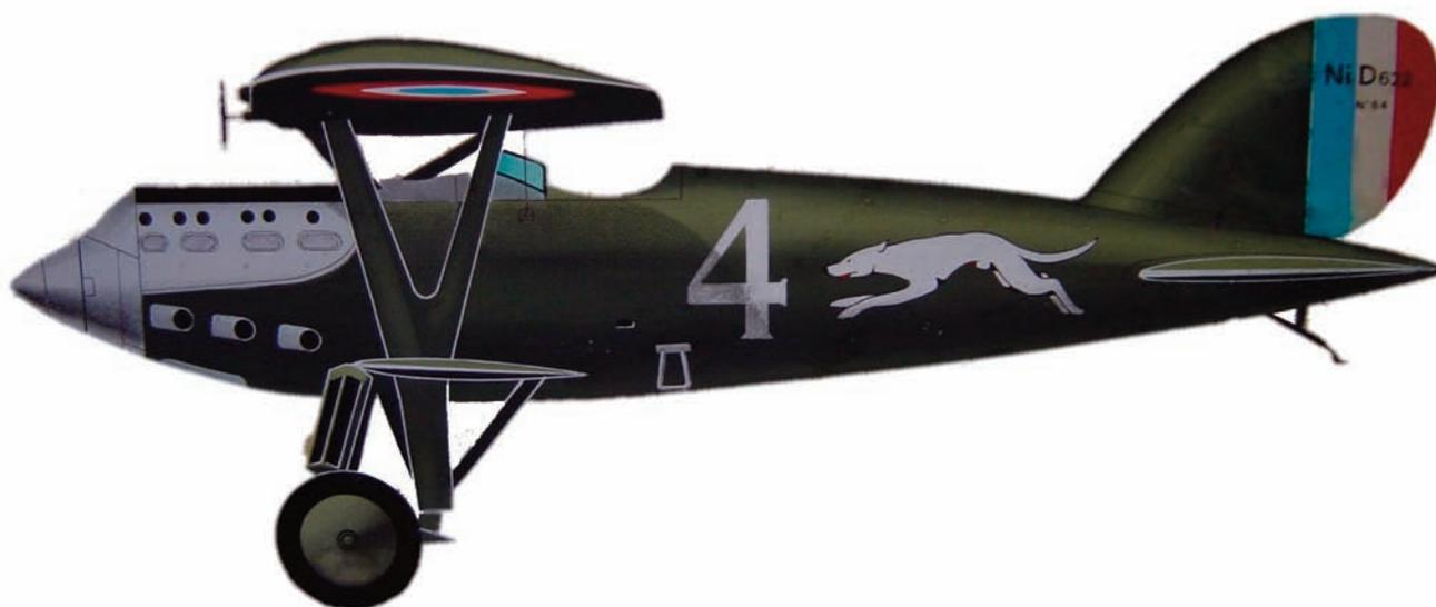
*Le Nieuport Delage 62 équipe les escadrilles à partir de 1929. Développement ultime du savoir faire français en matière d'avions biplans, il est équipé d'un moteur Hispano-Suiza 12 Mdsh en V de 500 ch. Pesant près de deux tonnes, il dispose d'un rayon d'action de 450 km, pour une vitesse maximale de 260 km/h. Son armement est constitué de deux mitrailleuses fixes de 7.7 mm tirant vers l'avant (Composition Jean-Jacques Petit , collection EC 01.004).*
