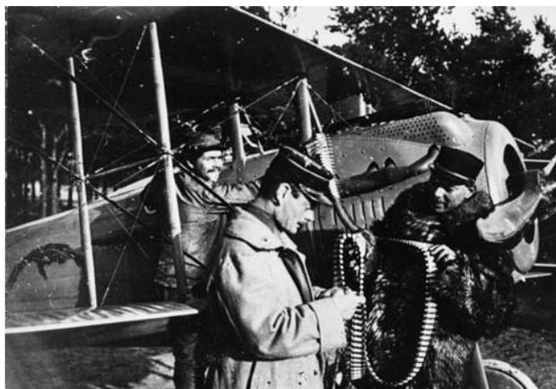
*Chaque pilote sait que sa vie dépend du bon fonctionnement de ses armes de bord. L'inspection méthodique de la bonne disposition des cartouches sur la bande d'alimentation des mitrailleuses permet d'éviter tout incident de tir pendant les phases de combat (Collection SHD).*
