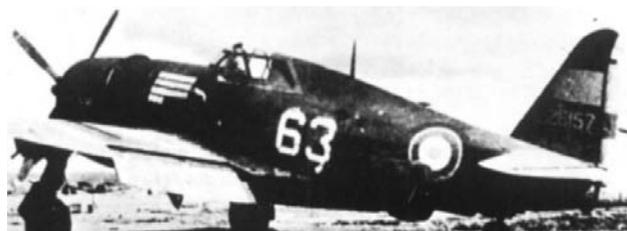
Le « 63 » est un P-47 D 22-R. La dénomination RE indique que l'appareil a été construit dans l'usine Republic Aircraft Compagny de Farmindale à Long Island NY. Les 22 RE se caractérisent extérieurement par leur hélice Halmiton Standard Hydramatic à moyeu rond. Le sérial number de l'avion, le 42-2615, indique que l'appareil a été commandé par l'USAAF dans l'année fiscale 1942 (Collection Vericel).
