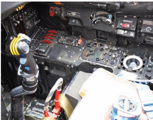
On peut voir au centre de cette photo le sélecteur d'armement de l'avion et les commutateurs de mise en œuvre des sécurités, à sa droite le calculateur de navigation à plaquettes perforées dont la confection occupa des générations de jeunes pilotes à l'instruction (Collection AO).
