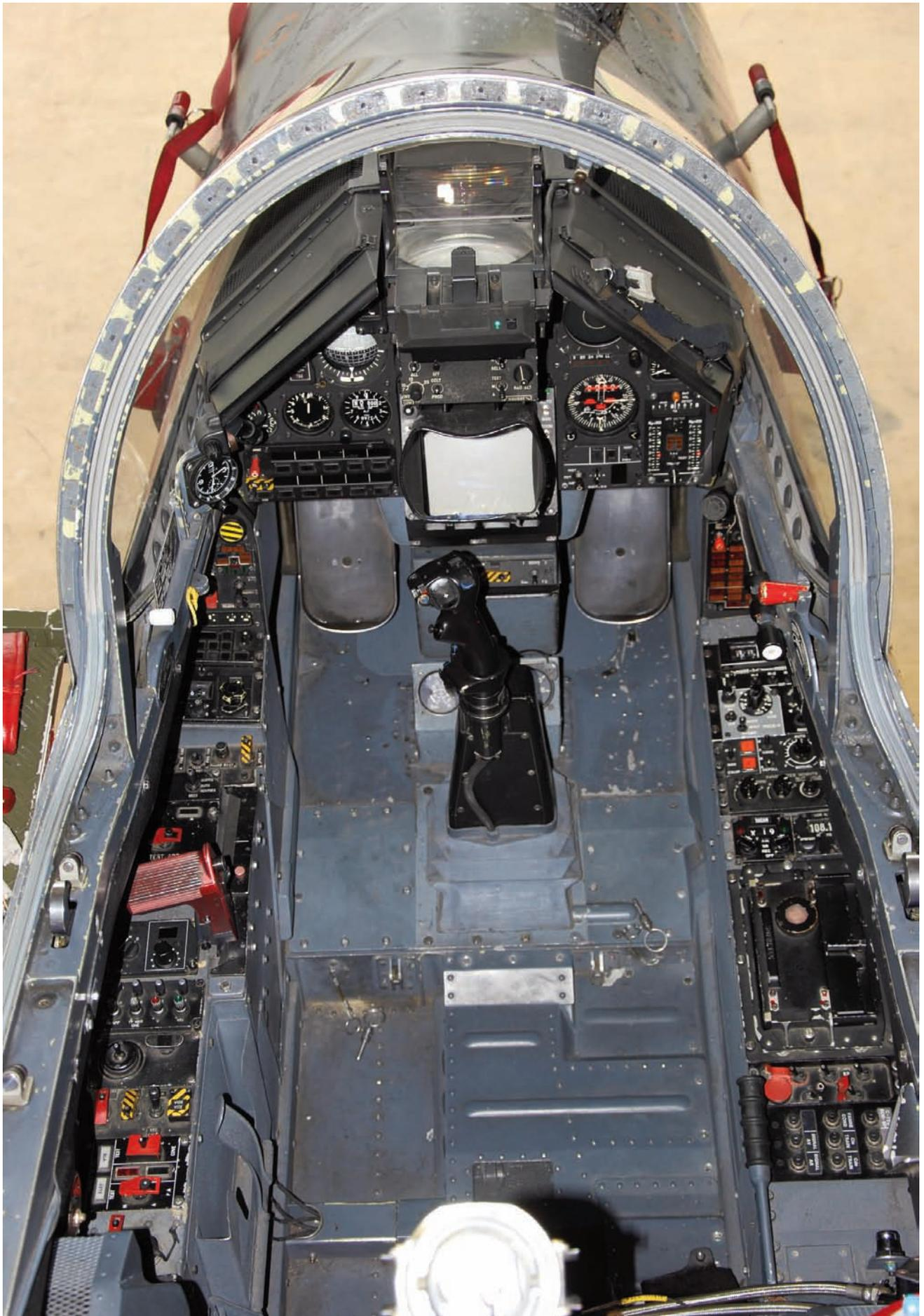
*Dans le Mirage 2000, l'homme fait corps avec sa machine. Le poste de pilotage est conçu autour de commandes multiplexées ergonomiques et fonctionnelles (Collection AO).*
