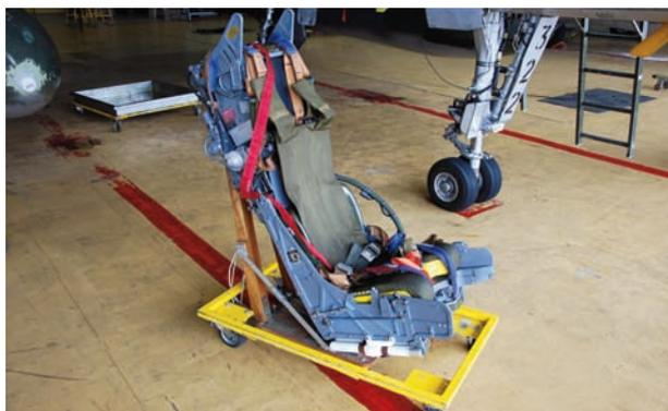
*Le Martin Baker Mk 10 F est un siège de type zéro-zéro. Pesant moins de 80 kg, il est mis en œuvre par une unique poignée basse actionnant les mécanismes pyrotechniques d'éjection. Le parachute est contenu dans le boîtier de tête et un paquetage de survie modulaire à séparation automatique assure l'assise du pilote (Collection AO).*
