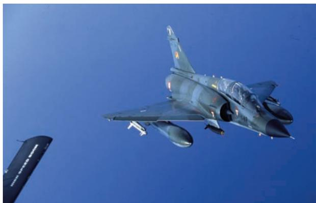
*La menace principale rencontrée par les équipages des Mirages 2000 N est de nature sol-air. Elle est représentée par les missiles de type SA-6 et SA-7 et par de l'artillerie anti-aérienne (AAA) de tout calibre. Pour y faire face les appareils disposent de dispositifs lance leurres infrarouges et électromagnétiques. Ils respectent des hauteurs minimales de vol pour rester hors du domaine de tir de l'armement adverse (Collection EC 01.004).*
