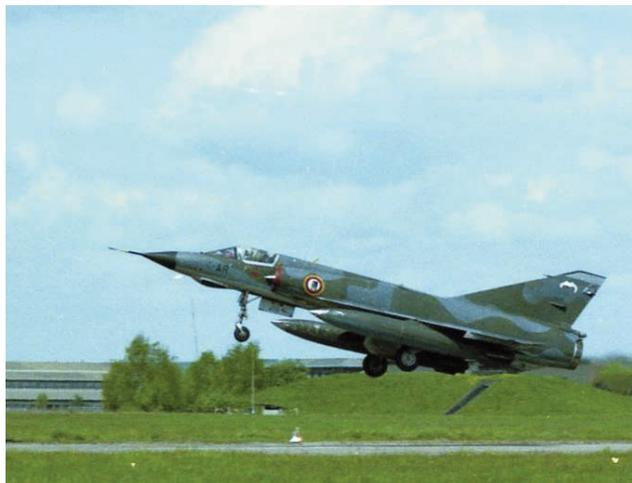
*Le Mirage III est un avion pointu à piloter et délicat à poser. Avion « d'homme », son atterrissage s'exécute sous une forte incidence et des vitesses élevées. Badin et ADEMAR sont à surveiller tout particulièrement, sous peine « d'ovaliser » la tuyère au poser des roues (Collection BA 116).*
