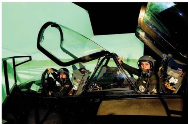
*Avec l'arrivée du 2000 N, l'escadre s'équipe de moyens de simulation performants. Ils permettent aux équipages de s'entraîner aux actions réflexes en cas de panne, tester l'avion aux limites, et pratiquer des exercices de vol sans visibilité. L'avènement de ces systèmes, conjugués à la technologie des CDVE, ont été un facteur déterminant dans les progrès accomplis dans le domaine de la sécurité des vols (DR).*
