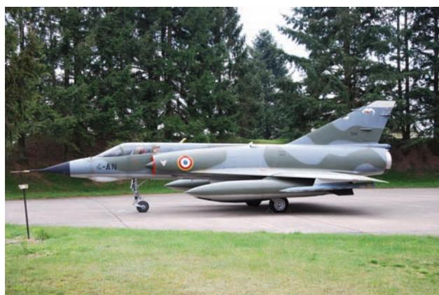
Mirage III E n° 584 « AN » de l'EC 01.004 « Dauphiné ». Cet avion magnifiquement restauré par une équipe de volontaires de l'escadron orne l'entrée de l'unité depuis 1995. On voit ici l'appareil en configuration standard pour un assaut nucléaire AN 52 sous pylône central, réservoirs pendulaires de 1.300 litres, lance-leurres PHIMAT à gauche et brouilleur électromagnétique de type BARAX à droite (Collection AO).
