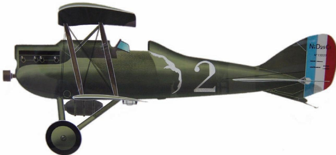
Le Nieuport Delage 29 C équipe «Lévriers» et «Charognards» de 1920 à 1929. Propulsé par un moteur Hispano-Suiza de 300 Ch, ce monoplace de chasse peut atteindre une vitesse maximale de 235 km/h. Doté de deux mitrailleuses Vickers de capot de 7.7 mm, il est dévolu à des missions de couverture de secteur pour les avions d'observation, œuvrant au profit des unités terrestres (Composition Jean-Jacques Petit, collection EC 01.004).
