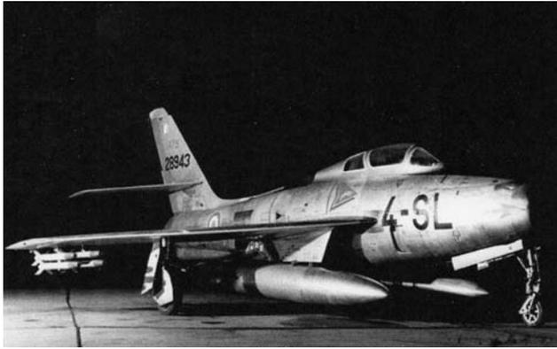
*Opérant exclusivement dans le cadre de la défense aérienne au-dessus de la vallée du Rhin, le « Dauphiné » voit ses missions évoluer vers l'appui-feu et le bombardement, plus en cohérence avec les possibilités offertes par le F-84 F et ses capacités d'emport. Cet appareil équipé de bidons de 450 gallons de de roquettes HVAR se prépare pour une mission d'entraînement à l'appui-feu (Collection EC 01.004).*
