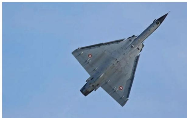
*Rare image d'un Mirage 2000 N en configuration lisse vu à Cazaux lors de la dernière campagne de tir de l'escadron. On note le détail des trappes de visite courant sous l'appareil permettant d'accéder aux différents équipements de l'avion ainsi que les becs de bord d'attaque sortis et les trappes additionnelles d'entrée d'air ouvertes (Coll. Tintillier).*
