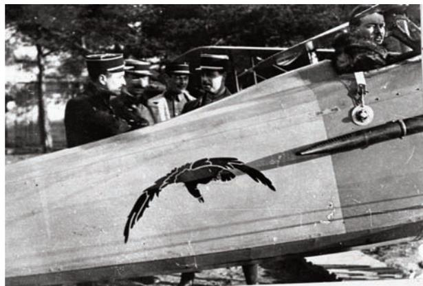
Pilotes de la SPA 37 discutant de la qualité de leur nouvel appareil, le SPAD VII. Doté d'un moteur en ligne Birkkit de 180 Hp, il dispose d'une mitrailleuse synchronisée Vickers de 7,62 mm tirant au travers du disque de l'hélice. Le SPAD est moins maniable que les Nieuport et la visibilité du pilote vers l'avant est médiocre. Rapide et véloce, il est cependant un redoutable adversaire en combat aérien (Collection SHD).
