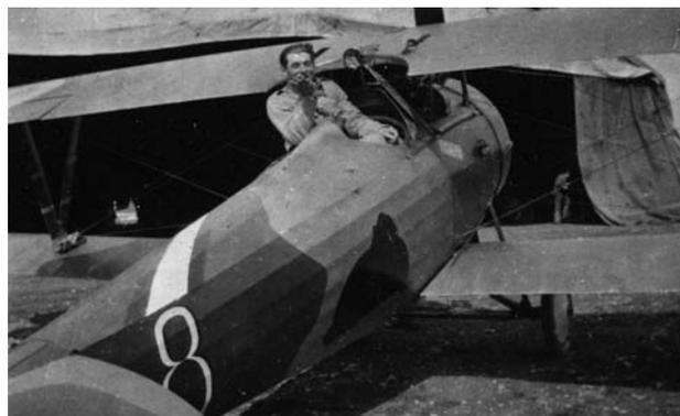
*Les Nieuport 24 et 27 sont issus d'une longue lignée de chasseurs qui ont permis à l'aéronautique militaire de briller notamment au-dessus de Verdun en 1916 et 1917. Le type 27 est équipé d'un moteur Rhône 9 Jby de 130 ch et d'une ou deux mitrailleuses Vickers de capot. Mais l'état-major lui préfère le SPAD XIII, mieux armé et au moteur plus robuste (Collection SHD).*
