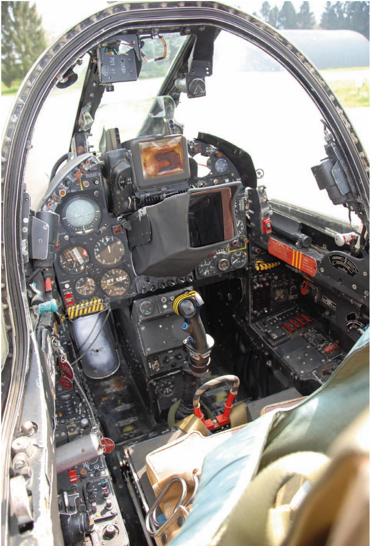
*Cockpit de Mirage III E. La conduite machine et l'utilisation du système d'armes sont complexes et demandent au pilote, une attention de tous les instants. On note, à gauche, le manche de commande du radar, la détente de tir sur la poignée pilote, ainsi que le marquage sortie de vrille jaune et noir (Collection AO).*
