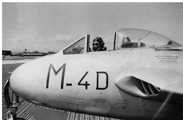
*A cette époque, le « Dauphiné » est identifié par la lettre « D ». La lettre de grand format est le code individuel de l'appareil au sein de l'escadron. Le pilote ne dispose pas de siège éjectable et l'évacuation doit se faire en quelque sorte en manuel. Le cockpit n'est pas pressurisé et les casques restent encore en cuir. Notez les goulottes de sortie des canons de 20 mm sous le nez de l'avion (Collection EC 01.004).*
