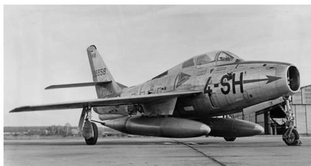
*En configuration « Sweep » à longue distance, le F-84 F perd de sa maniabilité, surtout en altitude. Les réacteurs de l'époque sont sensibles aux variations de régime et de facteur de charge brusques. Le pilote doit donc piloter avec souplesse s'il ne veut pas voir son réacteur s'éteindre en plein vol (Collection BA 116).*
